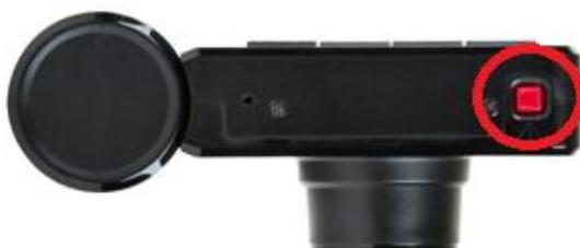
**手動緊急錄影：**在錄影過程中，請按行車記錄器底部的紅色按鈕，手動啟動「緊急錄影」模式。此時螢幕上會顯示緊急錄影警告圖示。
