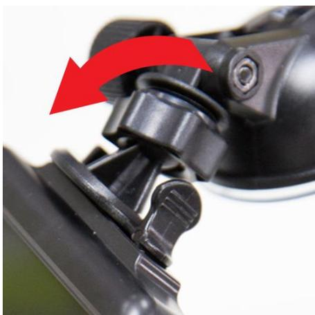
5. 當位置調整好，將環扣以順時針方向轉緊至最底部，以確保行車記錄器已完全固定。
